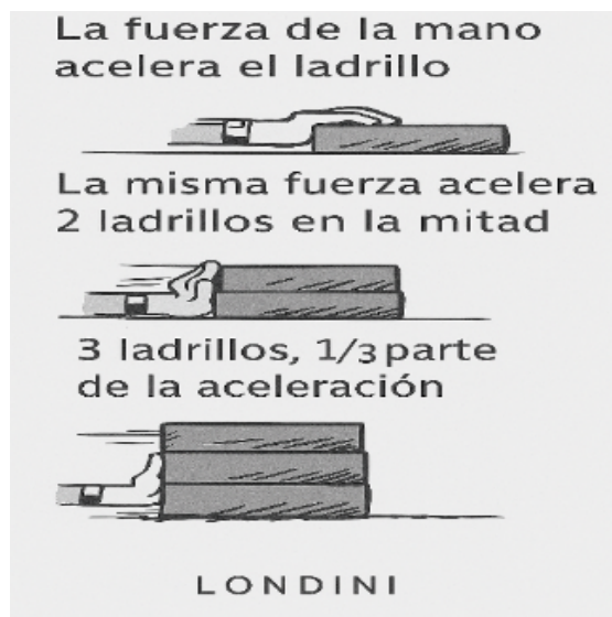
Figura 8. La aceleración es inversamente proporcional a la masa.
